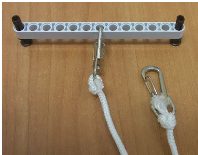
Рисунок Б.1 – Пример крепления каната к деталям робота
