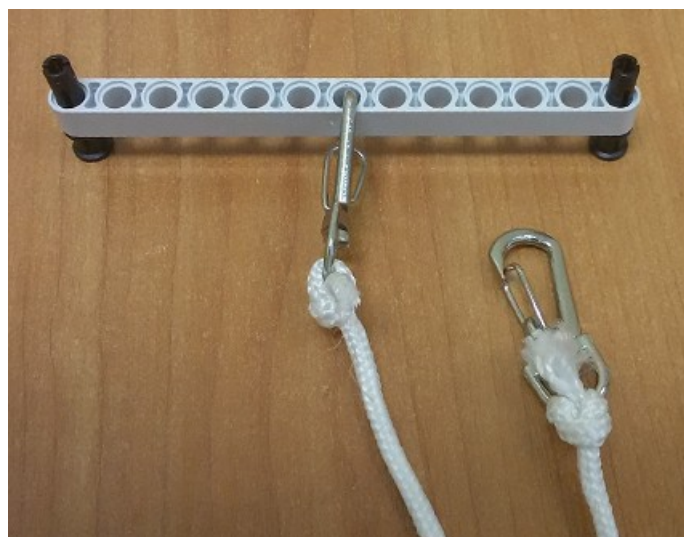
Рис. 4. Пример крепления каната к деталям робота
